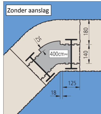
Figuur 54 + figuur 55: Smalle hoekzuil met een plaatselijk verbreedde kern
