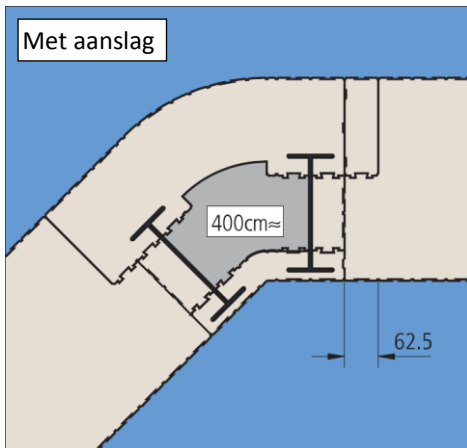
Figuur 54 + figuur 55: Smalle hoekzuil met een plaatselijk verbreedde kern
