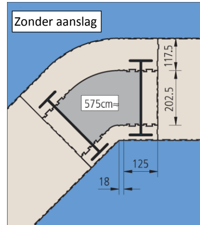
Figuur 52 + figuur 53: Smalle hoekzuil met een grotere betonkern
