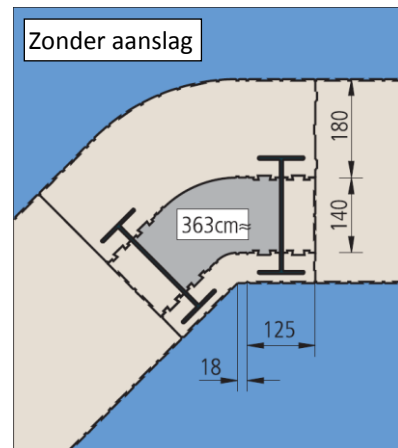
Figuur 56 + figuur 57: Smalle hoekzuil voor kleine belastingen en hoogtes
