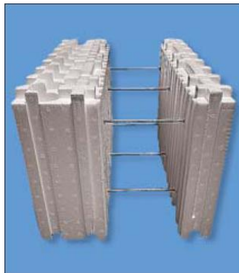
Figuur 26: Isorast 31,25 cm geluidsisolatie element: Brandwerendheids classificatie F 90 AB. Dit element voldoet aan alle eisen voor woningscheidende wanden
